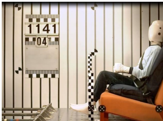
Рис 4а. Установка манекена.
