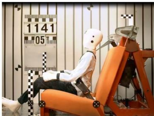
Рис 2б. Время 51 мсек. Манекен и положение ремня во время фазы нагрузки.
