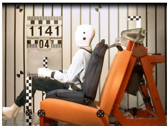
Рис 4б. Время 40мсек. Положение манекена и геометрия ремня во время фазы нагрузки.
